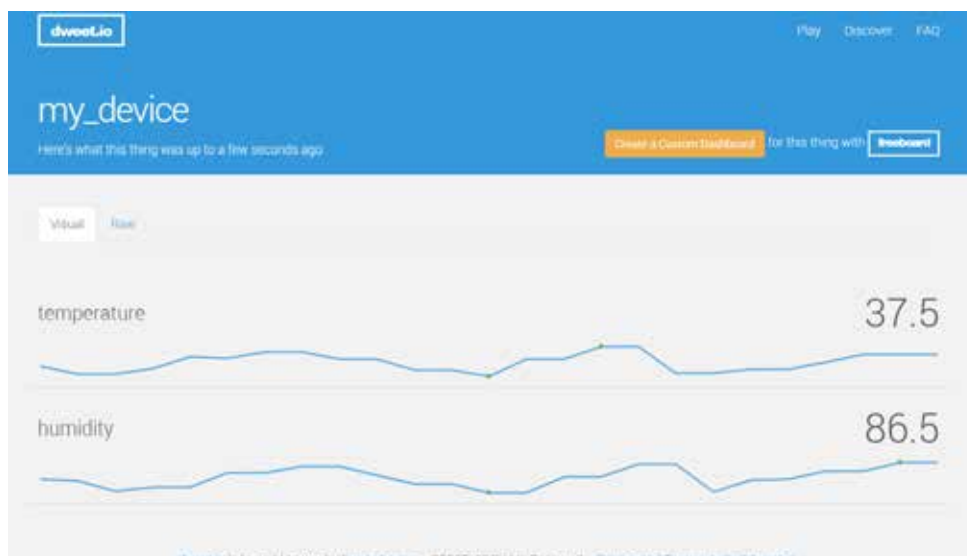
Рис. 3. Візуалізація даних про температуру та вологість, отримані від віддаленого датчика DHT22
